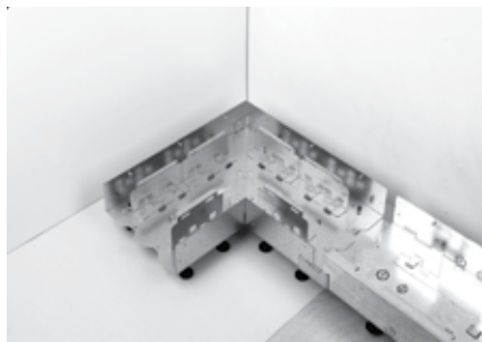
3. Les socles de la goulotte sont assemblés au moyen de jonctions et les extrémités de la goulotte sont couvertes avec les plaques de fermeture. Il est impératif que la chape ne rentre pas dans la goulotte. Les vis fournies sont utilisées pour établir une liaison électrique entre la jonction et les socles.
