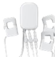
Pince ampèremétriques\* qui mesurent la consommation électrique et la production solaire au niveau de l'armoire électrique.
