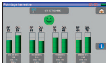
Pointeur terrestre avec affichage du nom des multiplex trouvés, pour assurer un réglage rapide.
