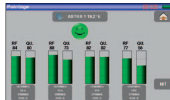
Pointeur satellite avec affichage de la NIT pour assurer un réglage optimal.
