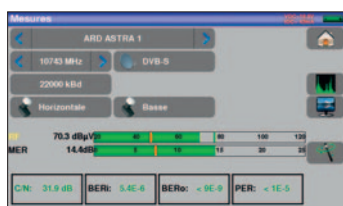
Mesures complètes avec identification "bon / mauvais" par un jeu de couleurs (vert et rouge).
