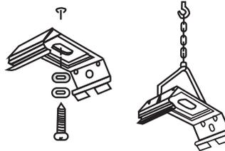
Installation avec étrier en acier inoxydable (inox 301) ou suspension (accessoires fournis)
