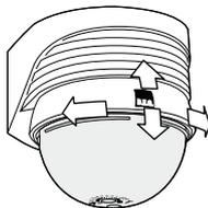
La plage de détection peut être modifiée en basculant la tête de détection horizontalement (env. ±45°) et verticalement (env. ±15°).
