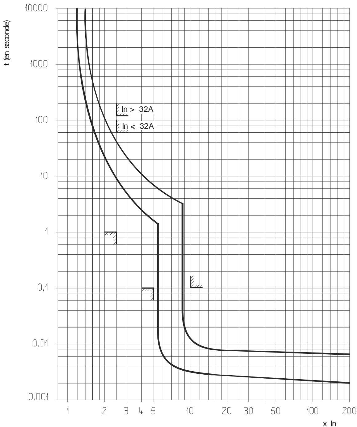
Déclenchement thermique temp. ambiant = 30°C
