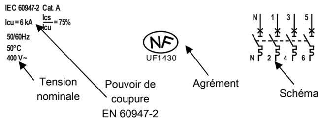
. Les bornes amont et aval du pôle neutre sont repérées par un « N » moulé à proximité des têtes de vis.
