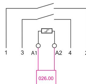
**Exemple de raccordement pour le type 026.00**
