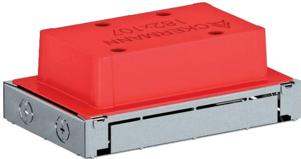
Boîte de raccordement sous plancher avec ouverture de montage fixe et non modifiable de 106 x 182 mm pour une unité d'installation de taille nominale 2. L'ouverture de montage est réalisée à l'aide d'un élément de coffrage compris dans la livraison. La boîte sous plancher présente sur la face avant des ouvertures de montage pour deux tuyaux d'installation M20 chacun. La boîte s'utilise principalement dans des planchers constitués d'une chape en ciment, d'une hauteur de montage de 70 à 90 mm.
