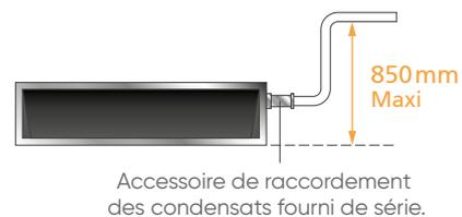
Accessoire de raccordement des condensats fourni de série.
