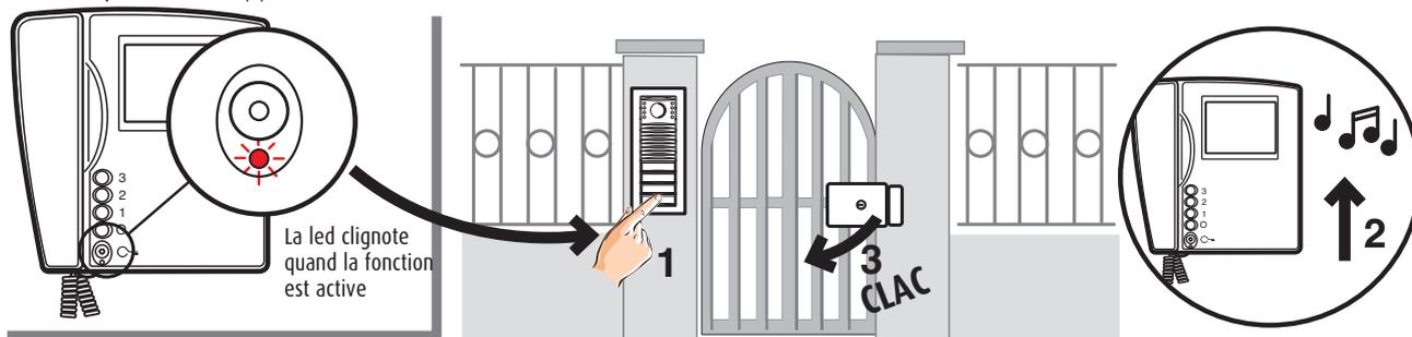
Appuyer sur la touche serrure pendant 10 secondes permet d'activer/désactiver la fonction (confirmée par un signal sonore).
