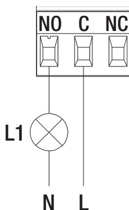
La fonction associée à la sortie OUT1 est "présence d'une alarme". Le voyant L1 s'allume en présence d'une alarme dans le système et s'éteint si aucun dysfonctionnement n'est détecté.
