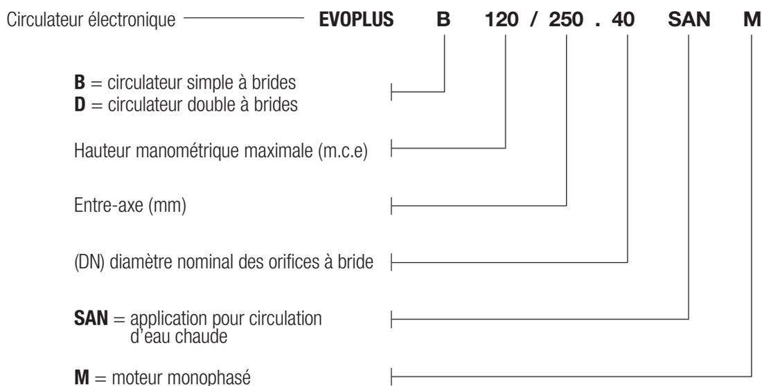
**Plage d'exploitation :** 2 à 12 m<sup>3</sup>/h pour des hauteurs manométriques de 11 mètres maxi.
