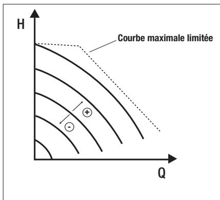
Ce paramètre de commande montre la courbe du circulateur à débit constant. La courbe de fonctionnement est choisie en réglant la vitesse de rotation selon un facteur de pourcentage, 100 % correspondant à la courbe maximale.
