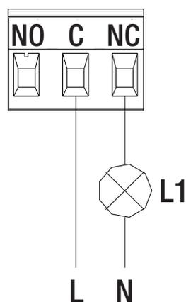
La fonction associée à la sortie OUT1 est "état de la pompe". Le voyant L1 s'allume lorsque la pompe fonctionne et s'éteint lorsque la pompe est arrêtée.
