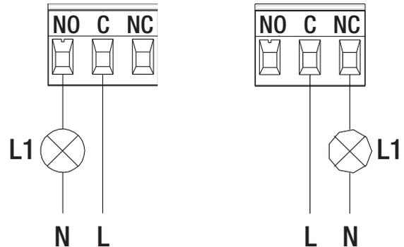
La fonction associée à la sortie OUT1 est "présence d'une alarme". Le voyant L1 s'allume en présence d'une alarme dans le système et s'éteint si aucun dysfonctionnement n'est détecté.
