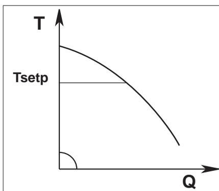
**Le mode de contrôle  $\Delta T$ -c maintient constante la température différentielle du fluide pompé en modifiant le débit de la valeur  $T_{setp}$  définie par l'utilisateur.**
