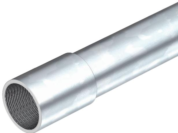
Tube d'installation électrique selon EN 61386-1 avec extrémités filetés selon la norme DIN EN 60423, pour la protection mécanique de câbles et de conduites. Avec paroi intérieure sans ébarbure. Classe de protection anticorrosion 2 (moyenne). Un manchon de raccordement est déjà vissé sur chaque tube.
