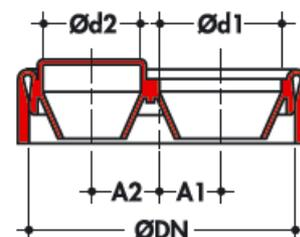
Se place sur l'emboîture d'une pièce série « à coller » permettant ainsi de la transformer en pièce « à joint ».
