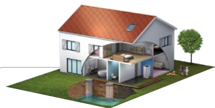
Captage eau de nappe
