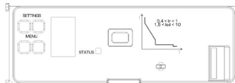
Écran LCD avec boutons de réglage, caisse de batterie et port USB.
