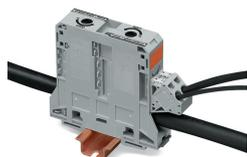
Prélèvement direct et sûr au point de l'alimentation ; l'enfichage de la borne de prélèvement s'effectue cage à ressort en position ouverte et sans conducteur.
