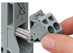
Prélèvement direct et sûr au point de l'alimentation ; l'enfichage de la borne de prélèvement s'effectue cage à ressort en position ouverte et sans conducteur.
