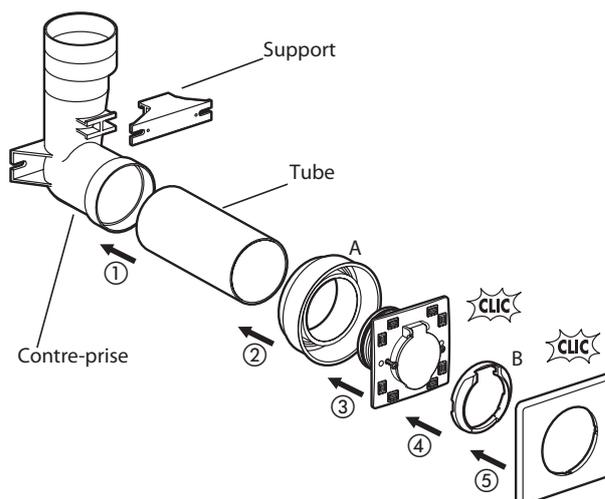
Cette prise d'installation peut être montée sur montage en mur périphérique, sur cloison de séparation ou en placard.
