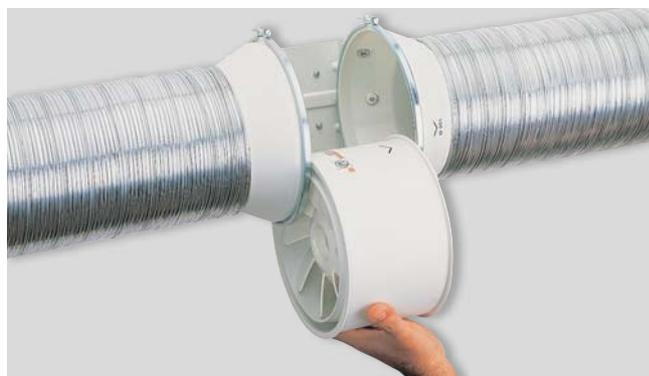
La conception unique des supports à brides de fixation permet au corps moteur-hélice d'être monté ou démonté facilement sans nécessité de démonter le conduit.
