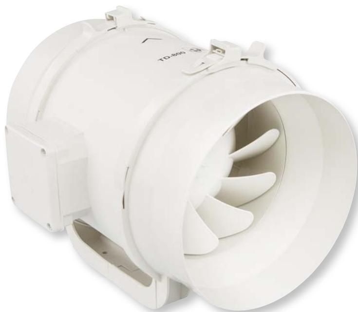
Ventilateurs hélico-centrifuges de hauteur réduite fabriqués en matériaux plastiques (jusqu'au modèle 800) ou en tôle d'acier protégée par une peinture époxy polyester pour les modèles supérieurs. Montage dans toutes les positions. La conception unique des supports à brides de fixation permet à l'ensemble moteur-hélice d'être monté ou démonté facilement sans nécessité de démonter le conduit.
