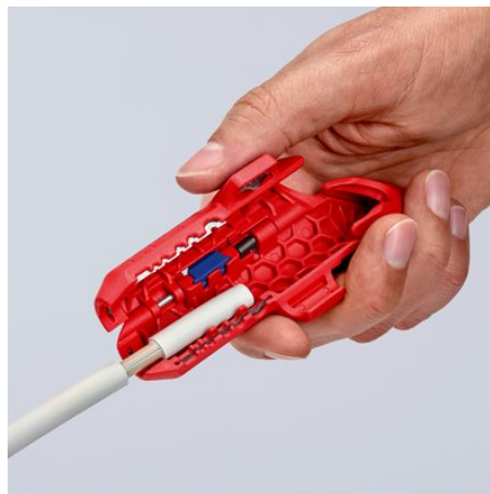
Dégainage d'un câble NYM
