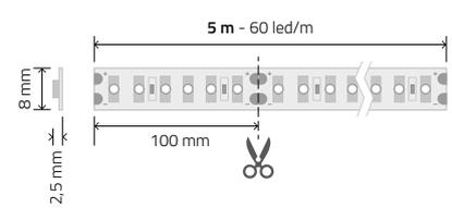
**!** Une installation sur un dissipateur thermique (profilé aluminium) allonge la durée de vie du produit.
