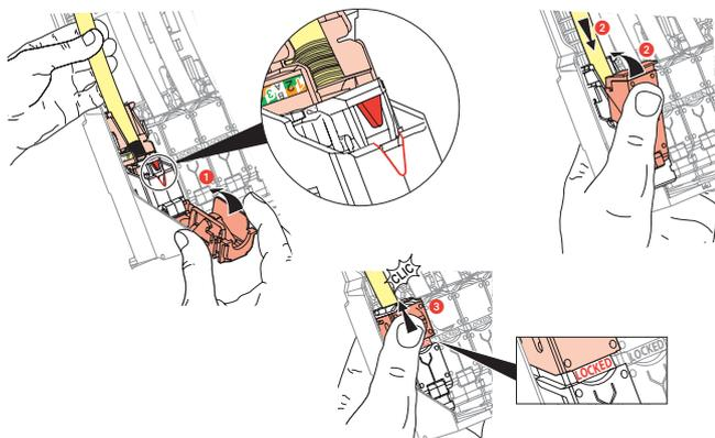
Ce système permet d'épanouir facilement les paires avant montage sur le connecteur.
