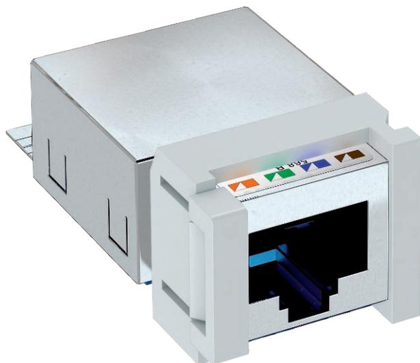
Noyau informatique Cat 6 blindé, avec un emplacement RJ45. Comprend un couvercle blindé CEM, un capuchon de protection contre la poussière, un connecteur de câble, un cadre de fixation Snap-In et une notice de montage. Convient au montage dans une plaque de support d'appareillages de types MTM 2C et MTM 3C, une plaque de montage de type MPR2 2C, un support de montage de types MTGE2 2C, MTGE2 15 2C et MTGE2 F 2C.
