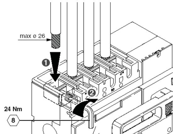
Bornes de raccordement pour câbles 300mm<sup>2</sup> (rigide) ou 240mm<sup>2</sup> (souple) - Cu/Al *réf. 262 50*
