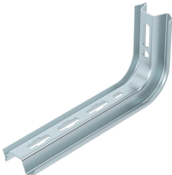
Profilé TP à utiliser comme montant léger sur les plafonds en béton horizontaux, longueur 145 à 645 mm. Jusqu'à la longueur de 345 mm, le profilé est également utilisé comme console murale ou de montant légère.
