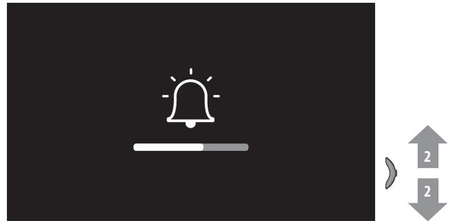
2. Actionner le joystick vers le haut/bas pour sélectionner le niveau (1 – 8) du volume.
