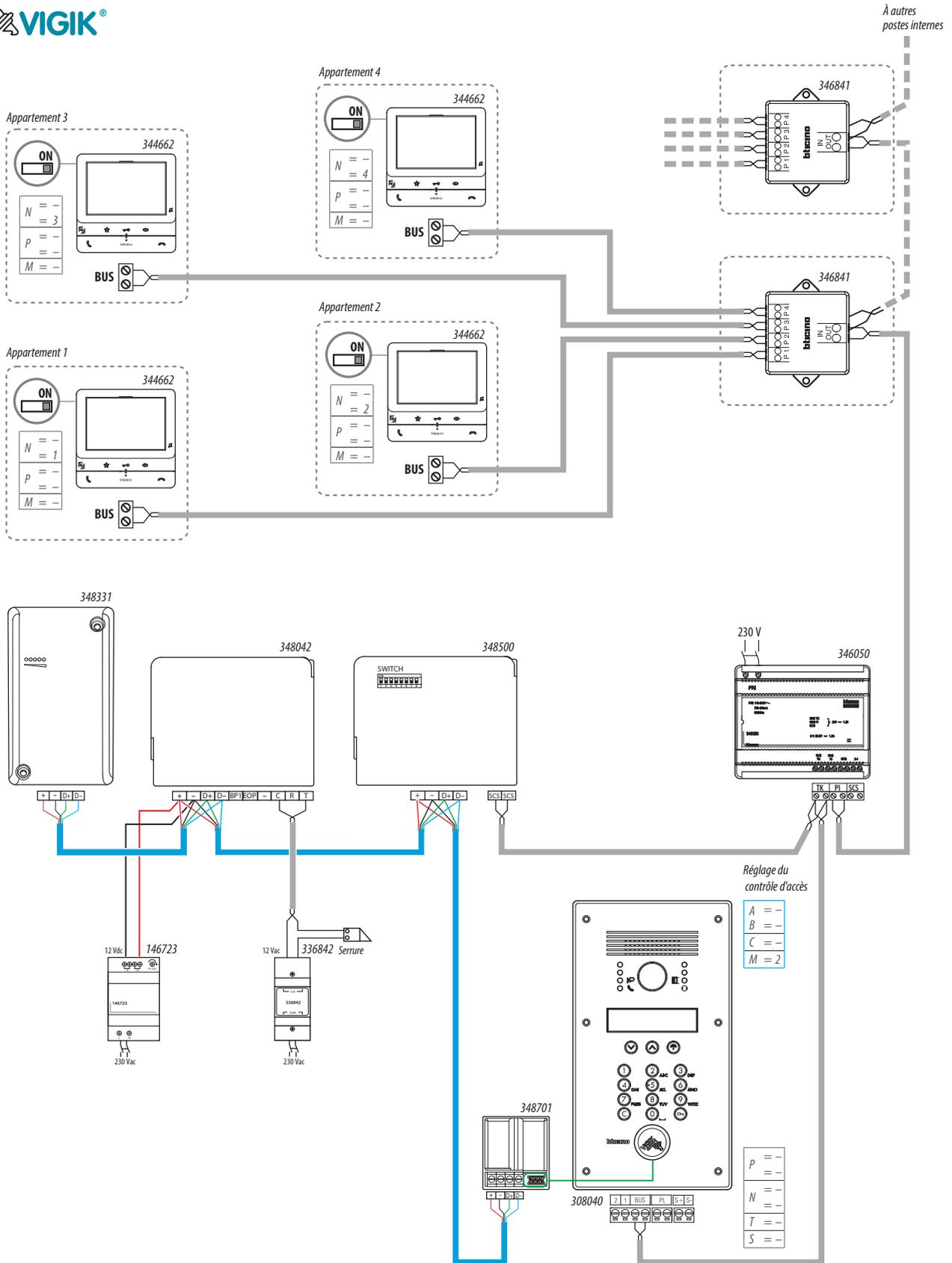
Pour utiliser le clavier codé intégré à la platine de rue Réf. 308040, rentrer dans le menu de configuration de la platine pour paramétrer «A/B» et «C» du clavier codé intégré à la platine. Dans cette configuration : A/B=00 ; C=0
