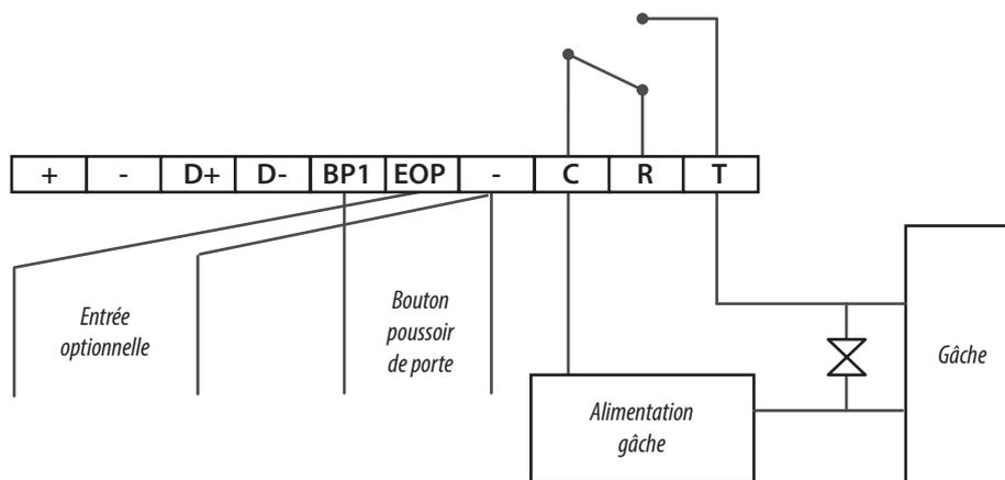
Au repos, la gâche maintient mécaniquement la porte verrouillée. Lorsque le relais est actionné par la centrale, le courant passe et la gâche libère la porte (appui sur bouton poussoir ou passage d'un badge autorisé).
