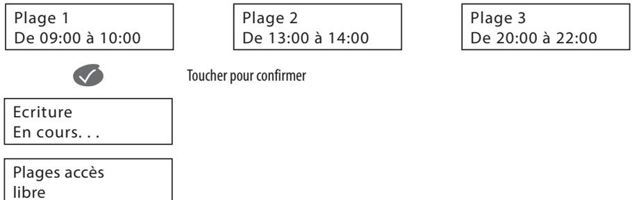
**ATTENTION** : ne paramétrez pas les plages d'accès libres sur des portes équipées d'une gâche électrique. La Centrale centrale de gestion 1 porte Hexact Plus mandant en permanence l'ouverture de la porte, il y aurait risque de détérioration de la gâche.
