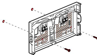
Fixation possible sur boîte d'encastement Ø 60 :
