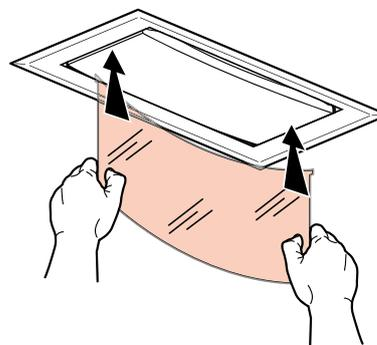
Plier légèrement le porte-pictogramme pour l'insérer dans le cadre d'encastrement.
