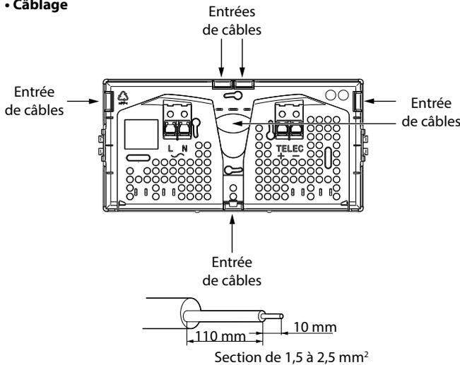
TELEC - Bornes de raccordement : pas de sens de raccordement avec la centrale Réf. 140 110.
