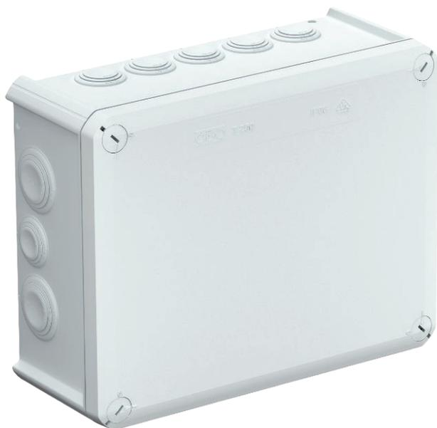
Les boîtes de dérivation de la série T sont toutes résistantes aux UV. Elles sont fabriquées en plastique thermoplastique, le polypropylène, et sont équipées d'embouts à tétine en éthylvinylacétate (EVA). Cette matière plastique est souple, c'est-à-dire malléable. Les câbles peuvent ainsi être installés à travers les 9 x M25
