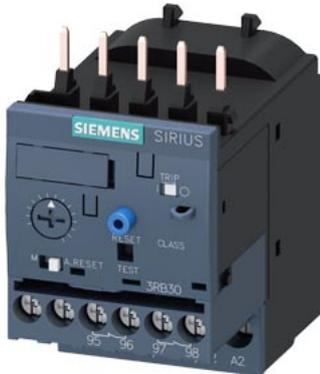
Relais de surcharge 3...12 A électronique pour protection des moteurs Taille S00, CLASSE 10E Montage sur contacteur circuit principal : à visser circuit auxiliaire : à visser Réarmement automatique/manuel
