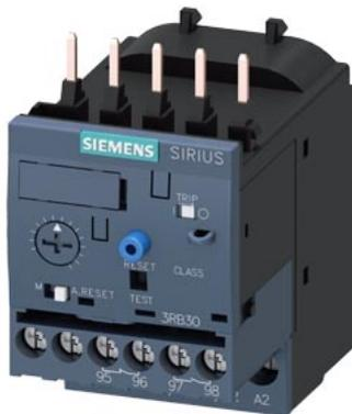
Relais de surcharge 4...16 A électronique pour protection des moteurs Taille S00, CLASSE 10E Montage sur contacteur circuit principal : à visser circuit auxiliaire : à visser Réarmement automatique/manuel
