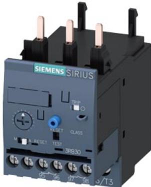
Relais de surcharge 6...25 A électronique pour protection des moteurs taille S0, CLASSE 10E Montage sur contacteur circuit principal : à visser circuit auxiliaire : à visser Réarmement automatique/manuel
