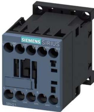
contacteur auxiliaire, 2 NO + 2 NF, 24 V DC, bornes à vis, taille S00
