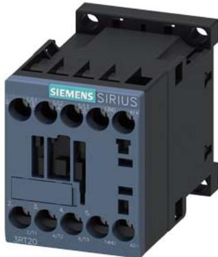
contacteur de puissance, AC-3e/AC-3, 12 A, 5,5 kW / 400 V, 3 pôles, 24 V DC, contacts auxiliaires : 1 NO, borne à vis, taille : S00
