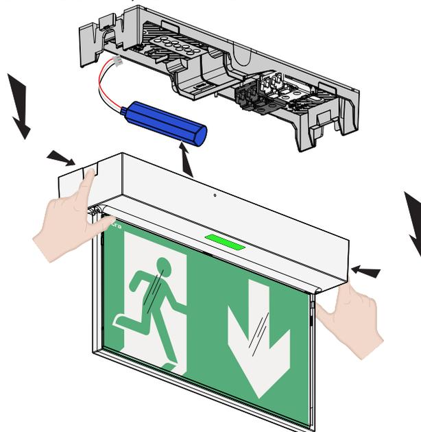
Les accumulateurs doivent être remplacés lorsque le bloc autonome ne satisfait plus à sa durée assignée de fonctionnement.
