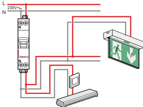
La dérivation peut se faire dans l'armoire électrique, sur l'interrupteur ou dans une boîte de dérivation. L'alimentation des blocs est soumise aux mêmes règles que les luminaires (câblage normal).
