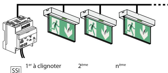
Ce paramétrage doit être fait avec la passerelle de configuration réf. 140 132 et l'application CloseUp. Cette action permet d'attribuer un numéro d'ordre qui indique la position du bloc dans la file.
