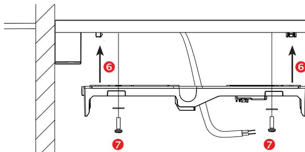
Raccordez l'embase et clipsez le bloc dans l'embase
