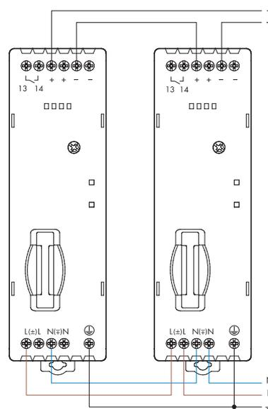
Schémas de raccordement pour 78.2E
