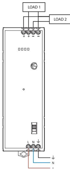
Schémas de raccordement pour 78.2K
