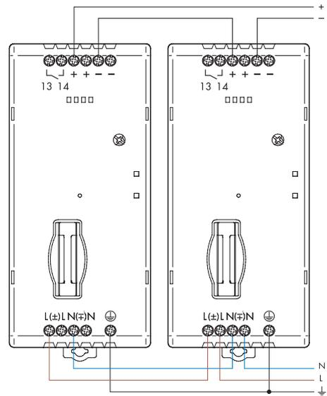
Schémas de raccordement pour 78.1A
