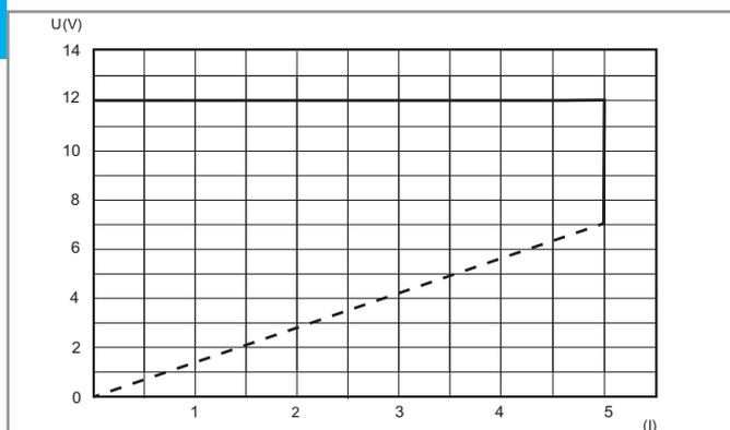
**FB78-2 Tension de sortie en fonction du courant de sortie (78.60/61)**
