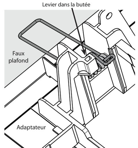
L'adaptateur est en place. Les 4 ressorts sont positionnés sur le faux plafond.
