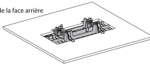
Pour un maintien renforcé, fixez-le, si nécessaire, avec un filin à la structure du bâtiment
