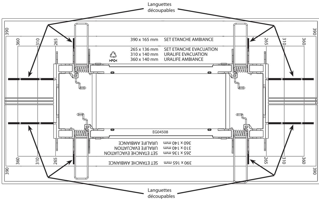
Réalisez, si nécessaire, les découpes des languettes de l'adaptateur avec une pince en suivant les indications ci-dessous :
