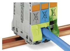
L'obturateur d'isolation jaune sert de protection contre le contact accidentel du logement de pontage et/ou des points de connexion sans conducteurs (divisibles).
