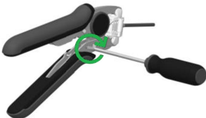
En cas de blocage, pour ouvrir la pince, utilisez un tournevis plat pour agir sur la vis située sur le manche mobile. Cette action permet de débloquer le cliquet qui permet le maintien de la pince fermée. Tournez la vis dans le sens horaire, la pince s'ouvre automatiquement.
