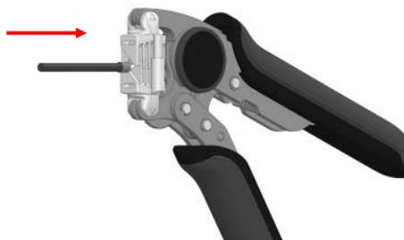
Amenez l'embout de câblage et le fil dans l'empreinte. La fêrle doit être entièrement insérée pour être totalement sertie.
