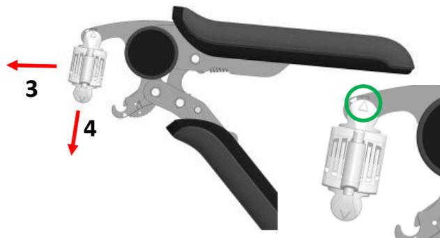
Basculez les mors vers l'extérieur (**sens 3**) afin que la flèche sur le mors supérieur s'aligne avec celle en noir sur le bâti. Tirez vers le bas (**sens 4**) pour dégager librement les mors.
